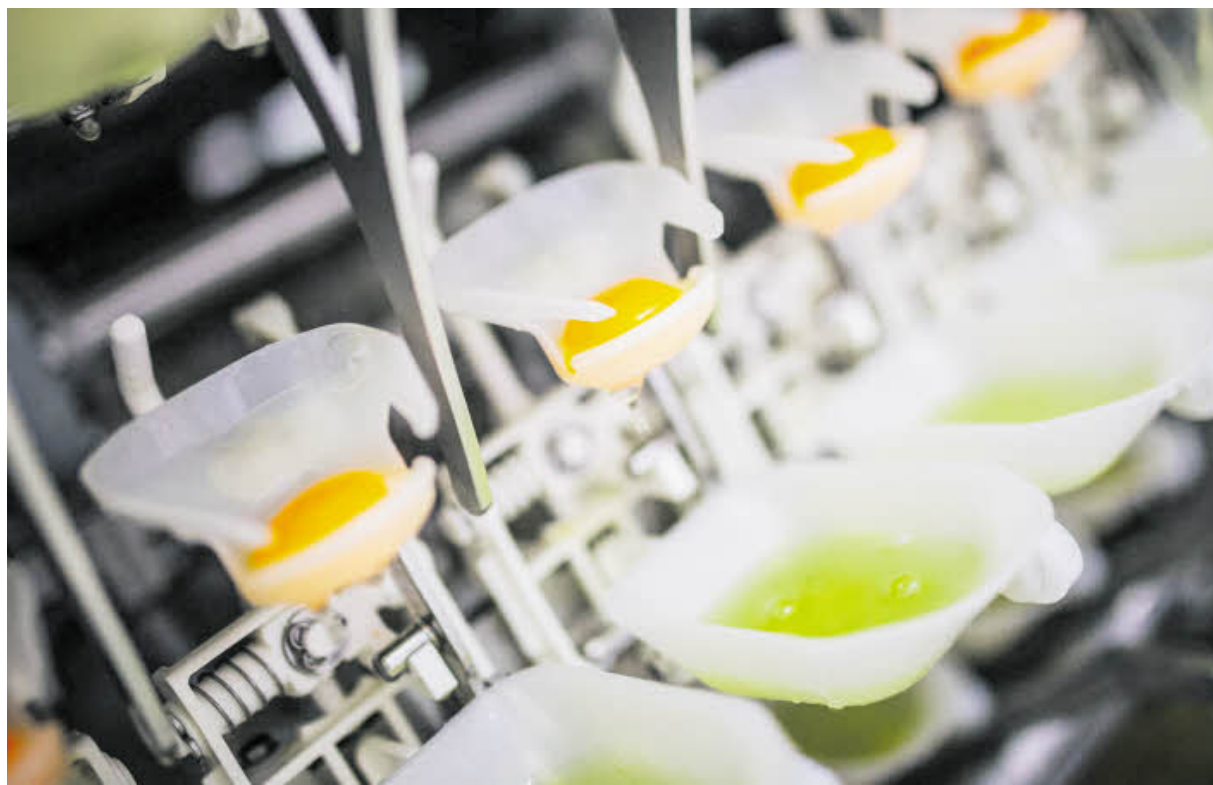
In Eiaufschlagwerken werden die Dotter vom Eiklar getrennt und für Fertigprodukte aufbereitet.
